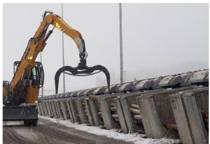
Auf Grundlage der Vermessungsdaten von Jörg Elektronik erfolgt die richtige Boxenzuteilung des Rundholzes
