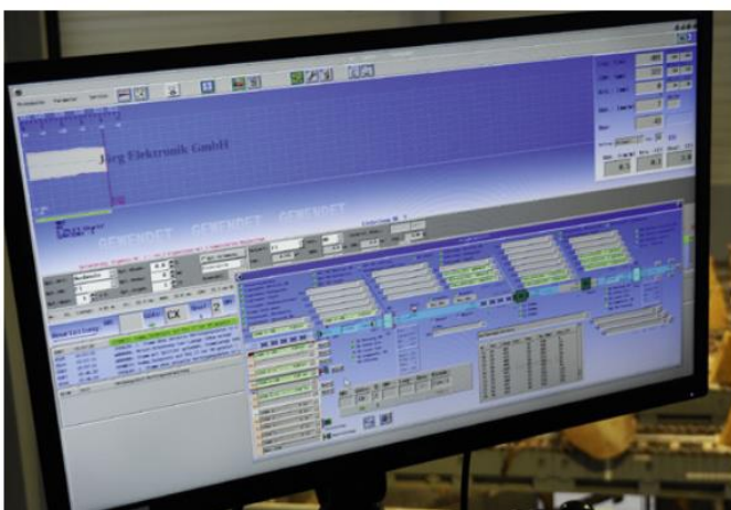
Jörg Elektronik lieferte die komplette Anlagensvisualisierung des Rundholzplatzes, Holtec steuert den Ablauf mittels SPS
