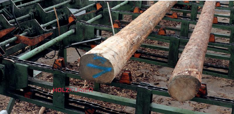
**3 Plattformlösung:** Die Software teilt den Langholzstamm direkt nach der Messung ein, eine Optimierung ist bis zum Restschnitt möglich
